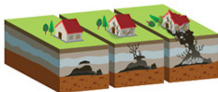
Effondrement de cavités
